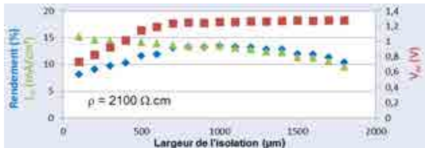
Figure 7 : Performances de deux cellules isolées par du silicium faiblement dopé en fonction de la largeur de l'isolation
