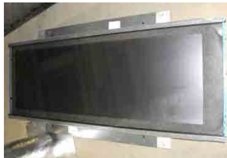
Figure 10 : Caisson pour capteur solaire (avec plaque alvéolaire installée à l'intérieur)
