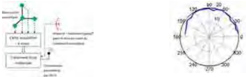
Figure 4 : Structure d'un nœud de localisation d'arc électrique par traitement hybride électromagnétique-acoustique
