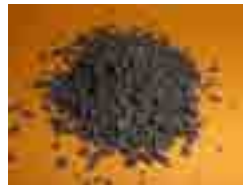
Figure 3 : mélangeur à rouleau en Boîte à gant et feedstock de NdFeB réalisé avec de la poudre monocristalline CEA5µm
