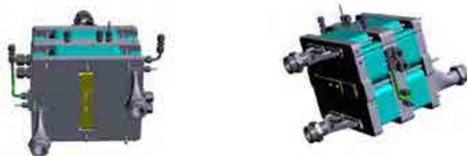
Figure 2 : Stack PEMFC 6kW constitué de 2x35 cellules incluant certaines innovations de conception
