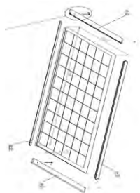
Figure 4 : Cadre en aluminium des modules PV, modules factices ou modules en verre
