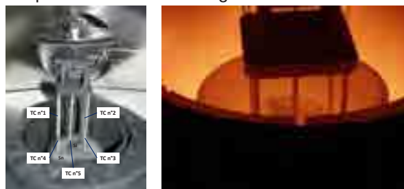
Figure 5 : Montage thermique constitué de 5 thermocouples de type – K et celui-ci au cours de la fusion
