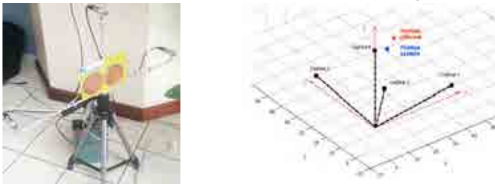
Figure 3 : Localisation de la source d'arc électrique à l'aide de la signature acoustique
