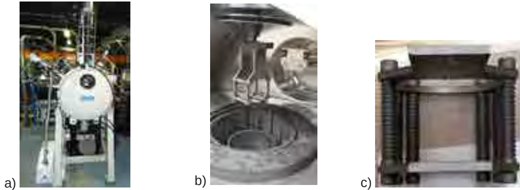
Figure 4 : Photos du four après réalisation et installation a) l'ensemble du four b) le cœur du procédé et c) le panier à wafer
